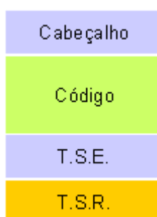
Figura 4.11: Arquivo objeto gerado através de compilação relocável
