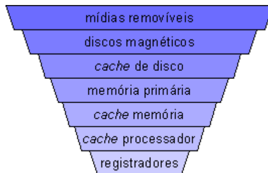
Figura 4.5: Organização típica de armazenamento
